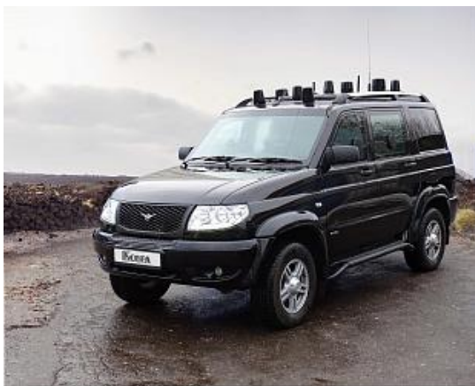
1-rasm. Avtomobilga o‘rnatilgan “Pelena-7M4” blokiratori
