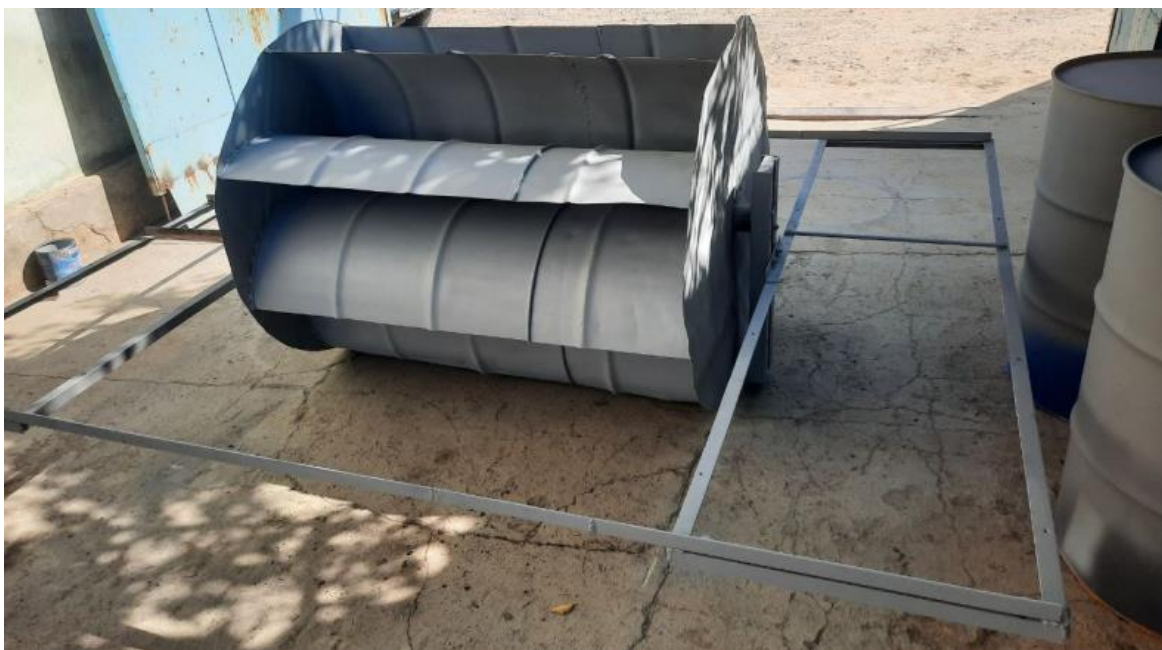
4-rasm. Kichik quvvatli mikro GESning ramasi va ishchi turbinasi
