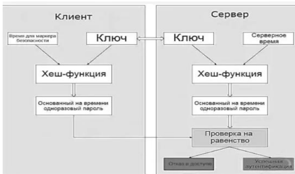
Рис. 1. Схема аутентификации клиент-серверной системы
