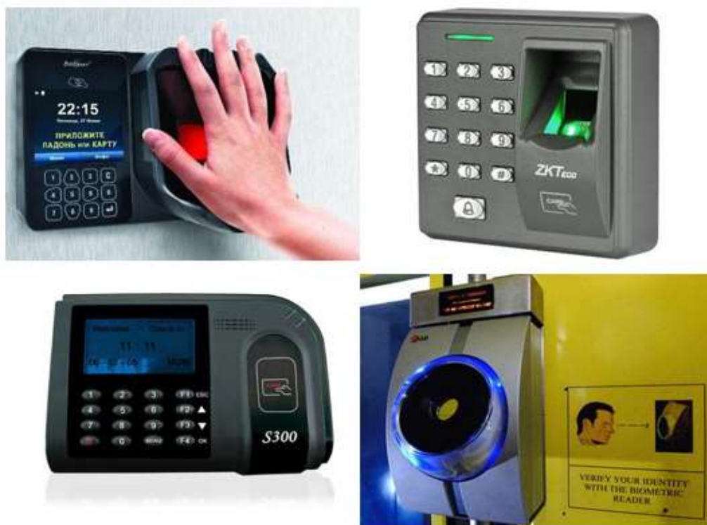
1-rasm Identifikatordan ma'lumotlarni o'qiydigan va uni boshqaruvchiga uzatuvchi qurilmalar.
