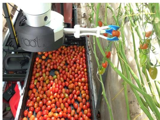
Рис.3. Робот с автоматическим управлением Virgo-1 в деле по сбору помидоров.
