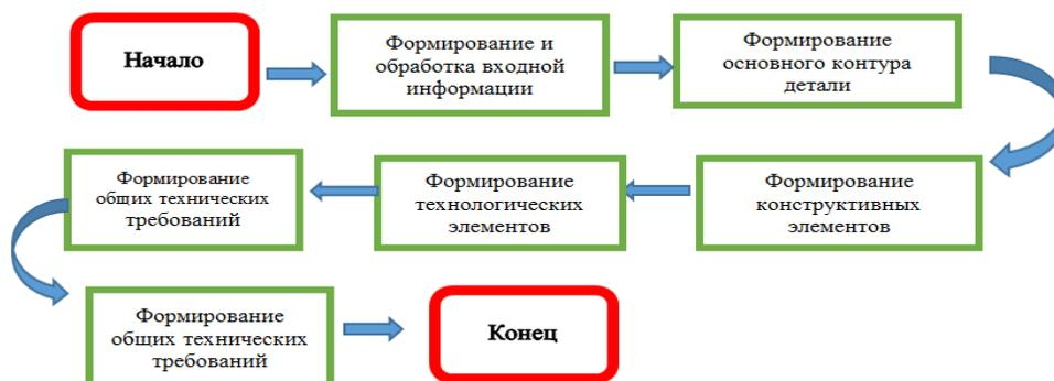
Рис.2.Алгоритм автоматизированного проектирования детали.
