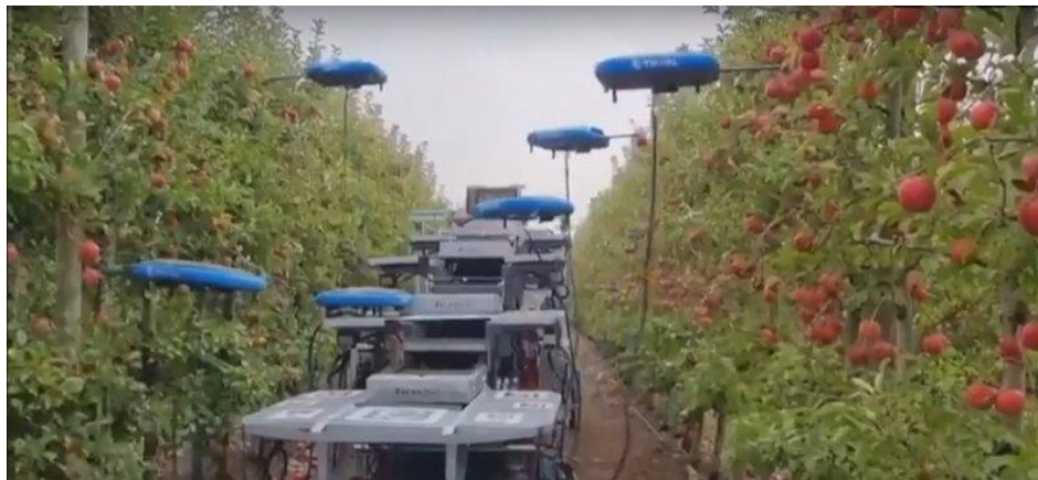
Рис.3 Квадрокоптеры с прикрепленной вытянутой рукой на яблоневом саду.
